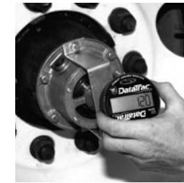
Installer le DataTrac® PRO sur le train de roulement.
