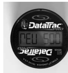
Modalidad REV muestra RPM o RPK para la cual la unidad ha sido programada.
