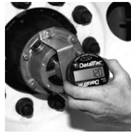
Instale el DataTrac® PRO en el terminal de rueda.
