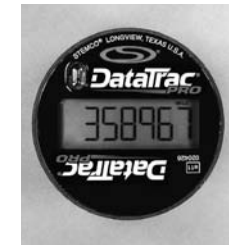
L'affichage s'allume quand le véhicule est au repos.
